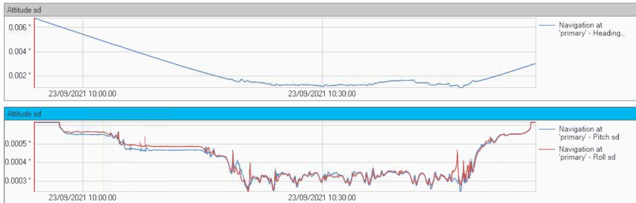
Figure 6: Précision estimée des angles de la trajectoire : heading (bleu, haut), roll (rouge), pitch (bleu, bas).
