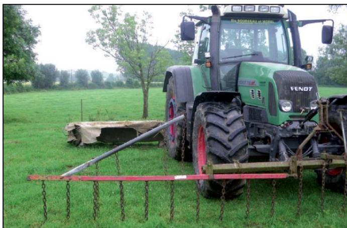
**Figure 8 : Barre d'effarouchement implantée sur un engin mécanique**
