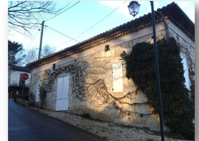
Toit plat à un pan avec présence de génoise, © Photographie UrbaDoc, 2013
