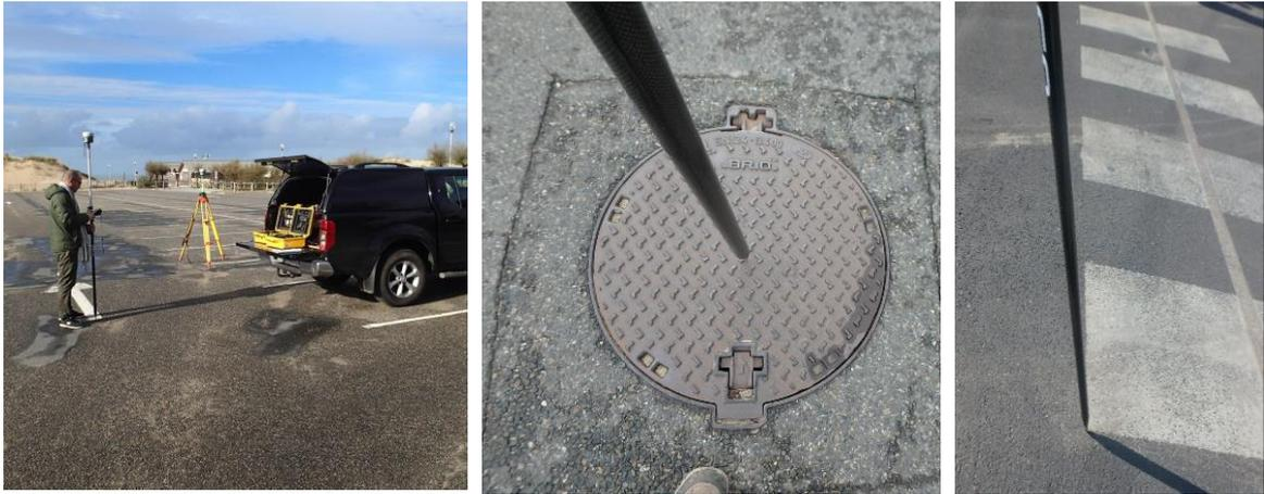
Illustration 1 - Exemples de levés DGPS, sur des repères remarquables, permettant de vérifier l'altimétrie et la planimétrie des données (à gauche : sur le parking d'accès à la plage d'Hourtin ; au milieu et à droite : sur la route à Soorts-Hossegor)
