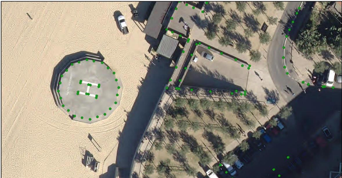
Illustration 2 - Exemple de vérification du calage de l'orthophotographie (Soorts-Hossegor). Les points verts correspondent aux mesures terrain. Dans cet exemple, les objets mesurés sur le terrain sont bien positionnés sur l'orthophotographie 2019 à Soorts-Hossegor : murs, marquages au sol, plateforme hélicoptère.
