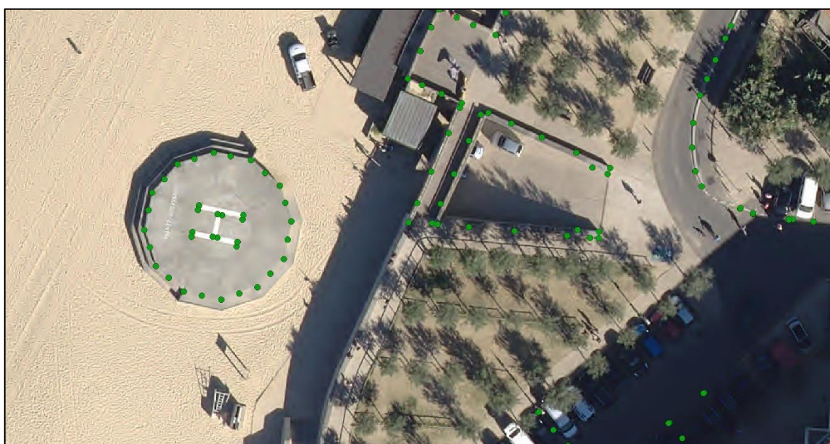
Illustration 2 - Exemple de vérification du calage de l'orthophotographie (Soorts-Hossegor). Les points verts correspondent aux mesures terrain. Dans cet exemple, les objets mesurés sur le terrain sont bien positionnés sur l'orthophotographie 2019 à Soorts-Hossegor : murs, marquages au sol, plateforme héliport.
