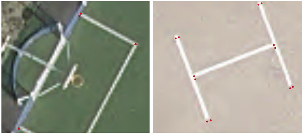
Illustration 3 - Exemple de vérification du calage de l'orthophotographie (Biarritz) ; les points rouges correspondant aux mesures terrain
